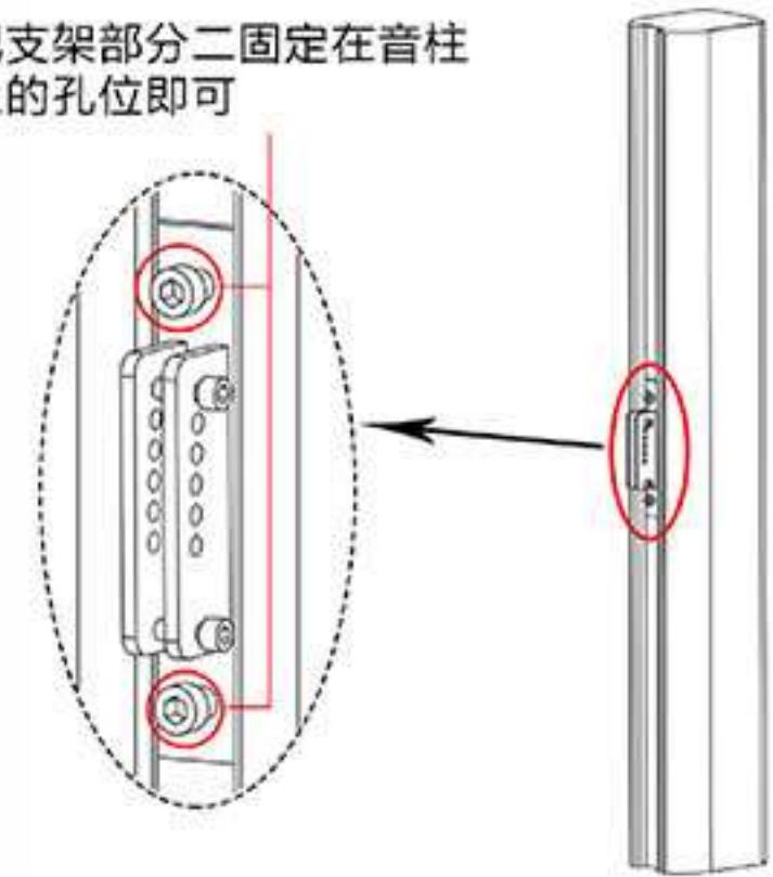
5. 先将装配好的支架二下方的螺丝挂至支架一上的钩槽，再根据需要的角度对准两部分支架上方的角度调整孔，锁上螺丝，即完成装配。
