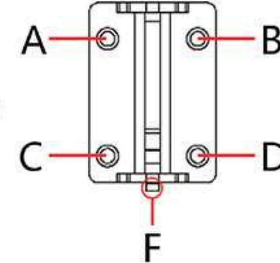
4. 将支架部件二装配至音柱背后两个支架安装孔上，注意支架方向，角度调整孔应位于上方。
