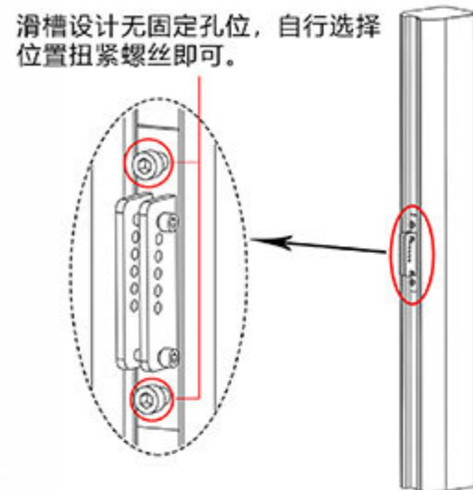
5. 先将装配好的支架二下方的螺丝挂至支架一上的钩槽，再根据需要的角度对准两部分支架上方的角度调整孔，锁上螺丝，即完成装配。
